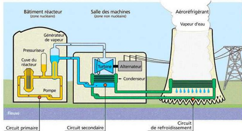
Le circuit primaire est le bâtiment du réacteur (zone nucléaire donc pas de visite dans cette partie). Après, il y a la salle des machines (zone non nucléaire) et le circuit de refroidissement (aéroréfrigérant) qui dégage de la vapeur d'eau.
